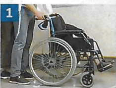
1. Begleitperson stellt sich hinter den Rollstuhl und kippt ihn leicht nach hinten.
